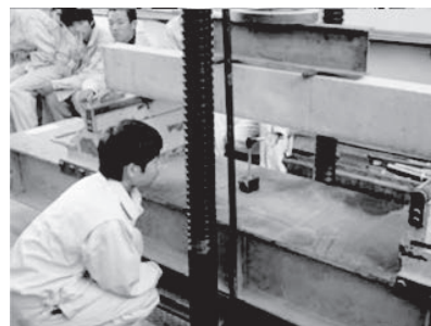
コンクリートの破壊試験
