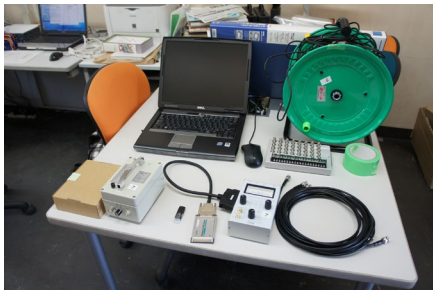
常時微動計測システム
