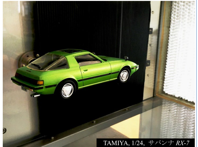
TAMIYA, 1/24, サバンナ RX-7 自作模型の流体力測定（抗力，揚力など）
