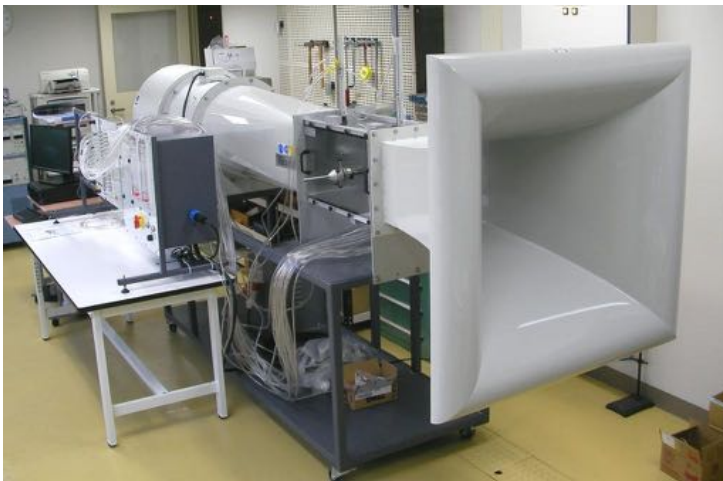
小型風洞実験装置 AF100 の外観
