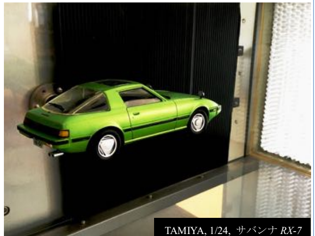
自作模型の流体力測定 (抗力, 揚力など)
