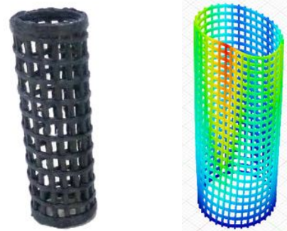
Fig.2 CFRTP3Dプリンターでの成形品と解析結果
