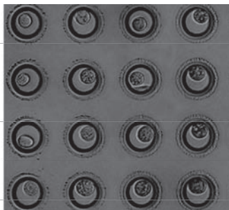
試作したマイクロウェルアレイ (直径：30 \mu\text{m} ，深さ：25 \mu\text{m} )
