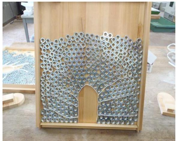
図3 ナットを使ったトンネルの模型実験
