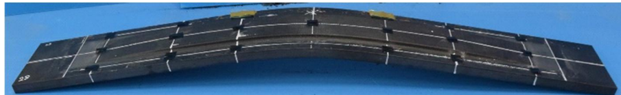
CFRP が接着接合された鋼板の曲げ試験後(CFRP 無しの時の 1.5 倍の曲げ剛性を確認)
