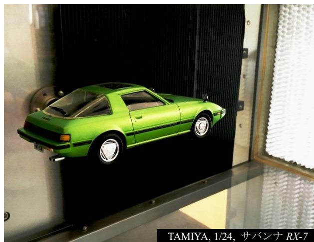
自作模型の流体力測定（抗力、揚力など）
