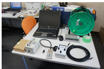
常時微動計測システム
