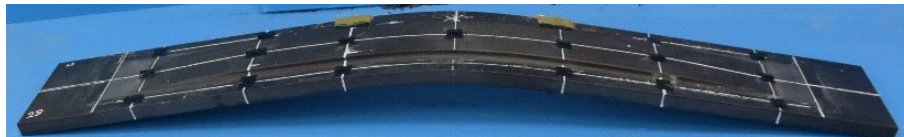
CFRP が接着接合された鋼板の曲げ試験後 (CFRP 無しの際の 1.5 倍の曲げ剛性を確認)
