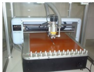
Fig. 2 自動基板加工機 (CADによる電子回路基板設計から直接試作可能)
