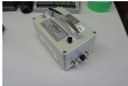
三軸微振動検出器(昭和測器:MODEL-2205)
